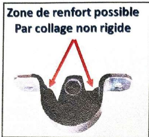
PHOTO 9 - Silentbloc d'origine sous longeron (traverse)
