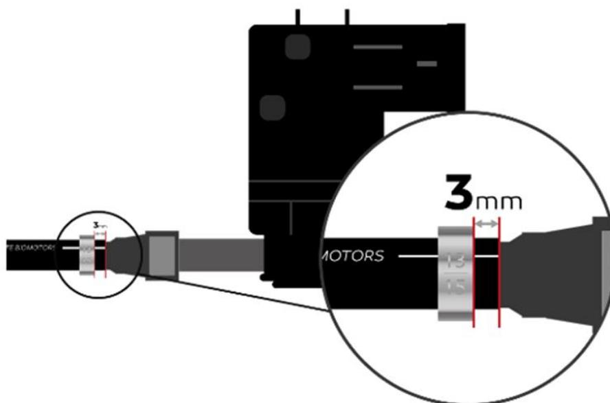
Le collier de serrage doit être fixé à 3mm de la butée.
