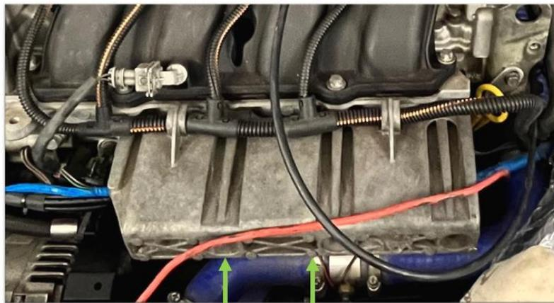
Placez la protection en Aluminium et mettre en place les écrous de 13mm
