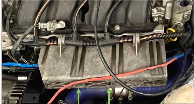
Déposez les 2 écrous de 13mm et retirez la protection en aluminium
