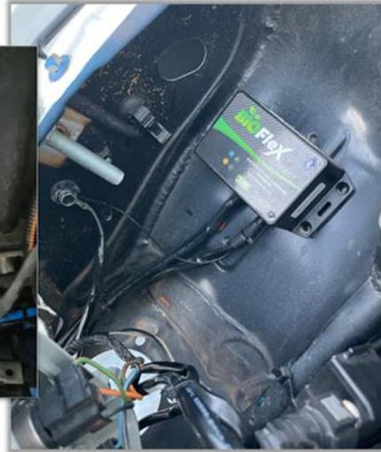
▶ Placez le boîtier à l'emplacement prévu a l'aide d'une fixation double face.
