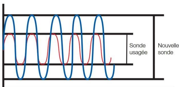
**Note :** Une sonde lambda a une durée de vie souvent limitée à 100 000km et souvent réduite en condition d'utilisation intensive. Si sa plage de fonctionnement est trop limitée (souvent constaté sur les TwinCup) pour permettre une lecture viable, il sera nécessaire de procéder à son remplacement.
