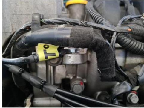
▶ Placez la sonde de température à l'emplacement prévu à l'aide d'une fixation M8x10.
