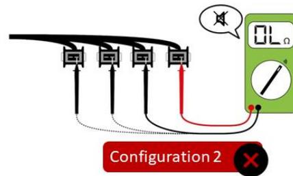
► Nous avons constaté que sur les twincup l'alimentation injecteur est systématiquement à gauche (configuration 1)
