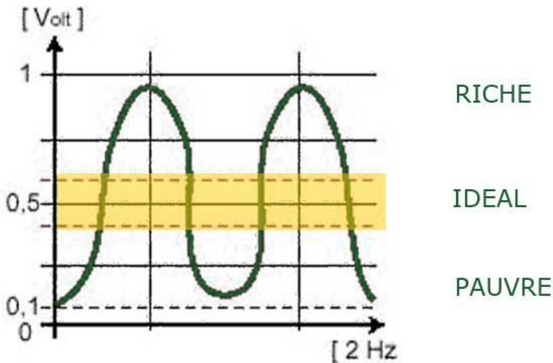
Les TwinCUP sont également munies d'une sonde lambda dont la valeur du signal de sortie oscille entre 0 et 1 volt, le réglage idéal de combustion se situe sur une moyenne de 0,5 volt.
