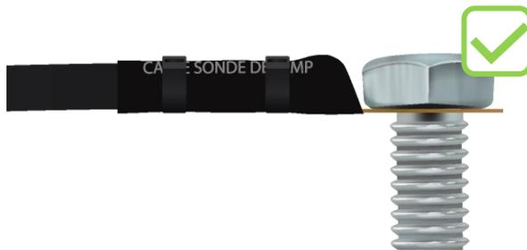
L'écrou ou la vis ne viennent pas écraser la sonde de température et le bulbe se situe bien vers le haut
