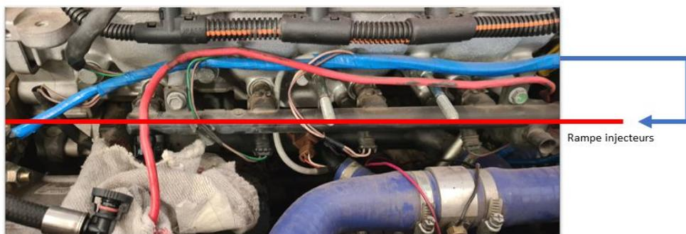
▶ Positionnez le faisceau du système Biomotors sous la ligne rouge pour éviter tout pincement des fils lors du remontage du cache en aluminium
